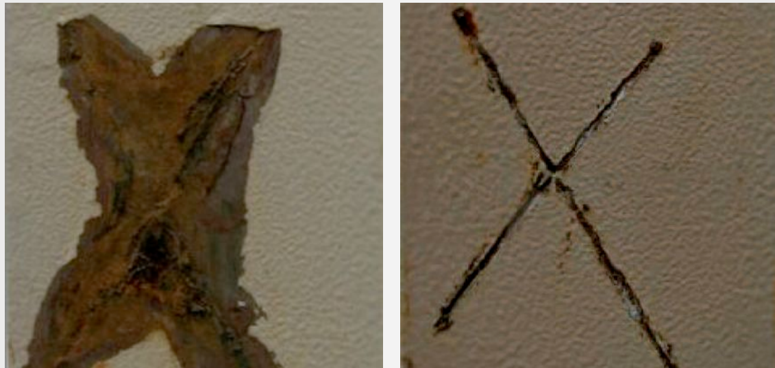
Eisenphosphatierung ohne und mit Passivierung nach 1000 h NSS
