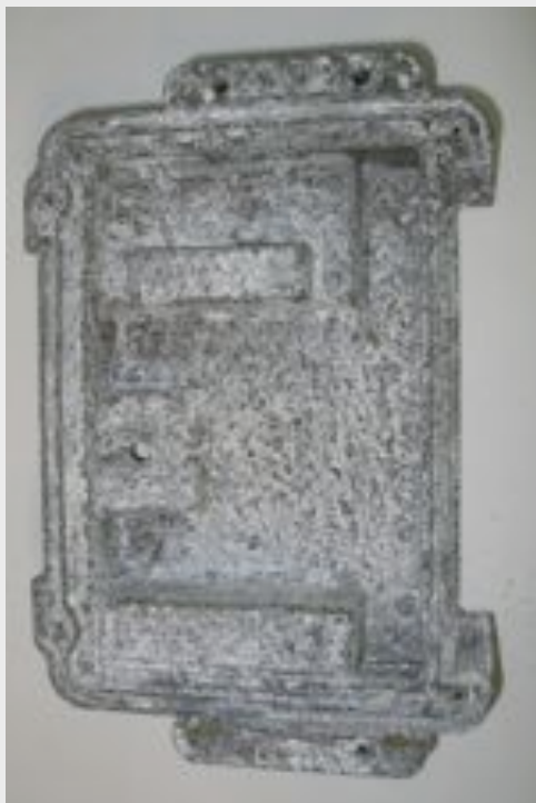
unbehandelt 120 h Salzsprühtest
