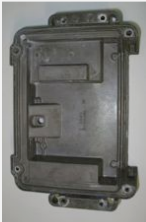
SurTec 650 – chromitAL 336 h Salzsprühtest
