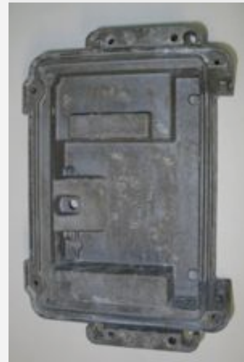
gelbchromatiert 336 h Salzsprühtest
