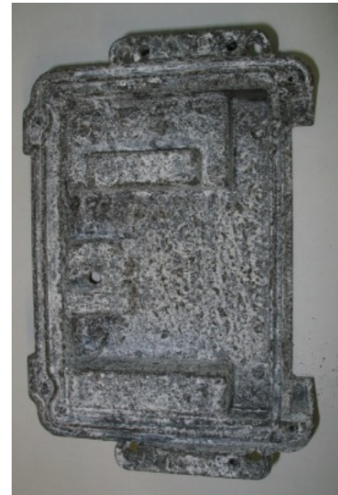
Unbehandelte Oberfläche, 120 h Salzsprühnebel
