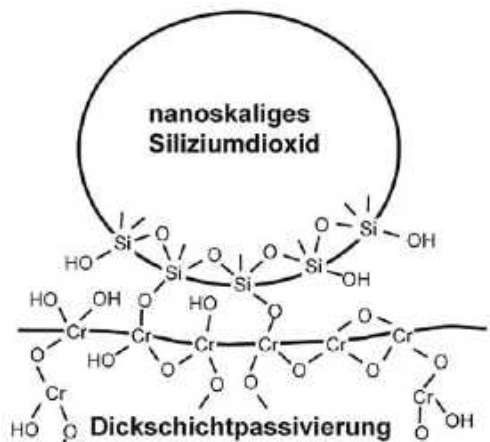
Abb. 4: Verankerung des Siliziumdioxides mit der Passivierungsschicht
