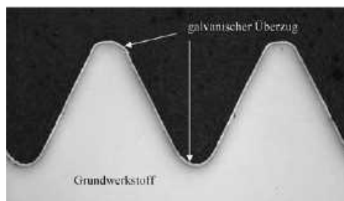
Abb. 1: Schichtdickenverteilung eines galvanischen Überzugs im Gewindebereich einer Schraube [6]
