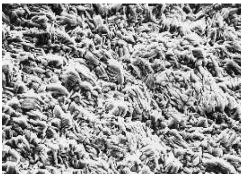
Abb. 5: Zinkschicht (2000fach), abgeschieden aus einem Chloridelektrolyten mit 2,5 ml/l SurTec 312, j = 140 \text{ A/dm}^2 , v = 70 \text{ m/min}
