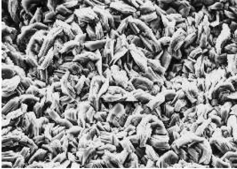
Abb. 7: Zinkschicht (2000fach), abgeschieden aus einem Sulfatelektrolyten mit 7 ml/l SurTec 307 I, 3 ml/l SurTec 307 II, j = 140 \text{ A/dm}^2 , v = 70 \text{ m/min}
