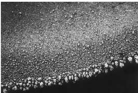
Abb. 14: Zinkschicht mit deutlich verringerter Dendritenbildung am Bandrand (400fach), abgeschieden aus einem Sulfatelektrolyten mit 7 ml/l SurTec 307 I und 3 ml/l SurTec 307 II, j = 200 \text{ A/dm}^2 , v = 70 \text{ m/min}
