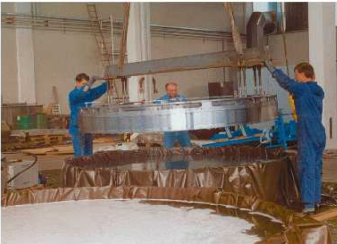
Bild 1. In drei planschbeckengroßen, runden Stahlwannen, von denen zwei mit Folie ausgekleidet sind, wird High-Tech produziert. Im Vordergrund ist das Beizbad zu sehen, das durch die Wasserstoffentwicklung aufgeschäumt ist
