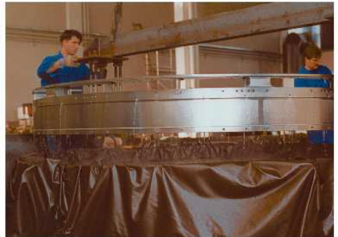
Bild 2. Der Teleskopring hat einen Durchmesser von 2,7 Metern. Der obere Teil besteht aus vielen Taschen mit Stegen, die nach außen offen sind. Der untere Teil ist hohl. Problematisch bei der Beschichtung sind die zahlreichen Bohrungen und Sacklöcher
