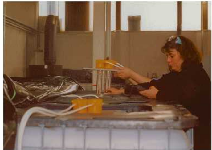
Bild 4. Das lilafarbene Chromitierbad wurde über Nacht mit vier Tauchsiedern auf 80 °C vorgeheizt. Vor Einfüllen des Bades in die Wanne wird die Temperatur nochmals genau kontrolliert. In der Wanne erfolgt die Chromitierung bei 60 °C
