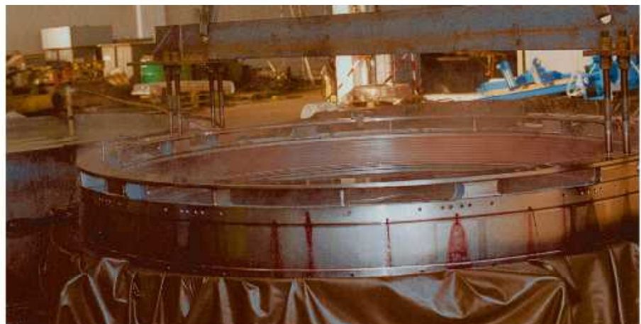
Bild 5. Herausheben des Teleskoprings aus der Chromitierlösung. Deutlich sind die Ablaufspuren aus den Bohrungen und Sacklöchern zu sehen
