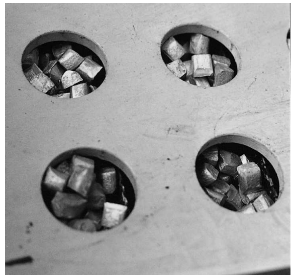
Bild 2. Das mit dem Wasserstoffkatalysator ausgestattete Zinklöseabteil erlaubt aufgrund der schnelleren Auflösung eine kleinere Auslegung
