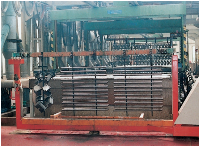
Bild 3. Pro Schicht fahren circa 120 Warenträger durch die beiden Verzinkungsanlagen
