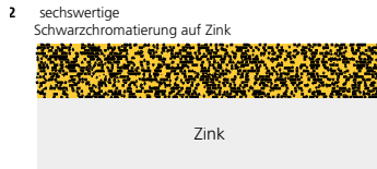
Abb. 3: Schematische Darstellung der sechswertigen Schwarzchromatierung auf Zink; in die Matrix einer Gelb- oder Olivchromatierung sind schwarze Pigmente (feinverteiltes Silber/Silberoxid) eingelagert
