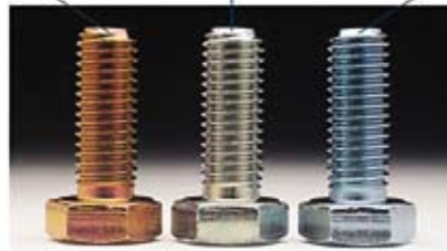
Bild 2: Korrosionsschutzschicht bei: a) Gelbchromatierung, b) Dickschichtpassivierung, c) Blauchromatierung
