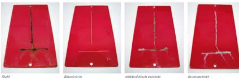
Bild 14: Verschiedene mit SurTec 609 ZetaCoat vorbehandelte Materialien nach 6 Zyklen Klimawechseltest
