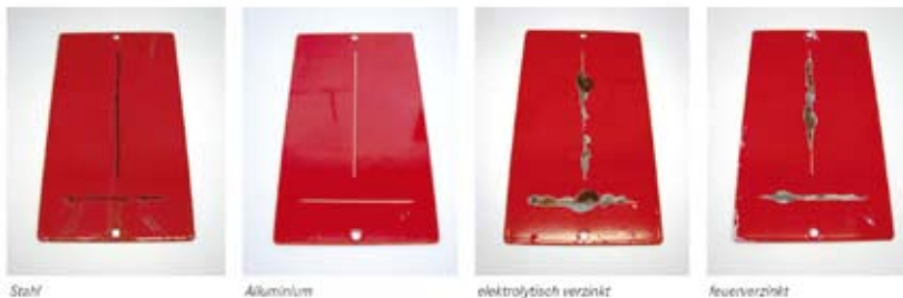
Bild 13: Verschiedene mit SurTec 609 ZetaCoat vorbehandelte Materialien nach 600 h Salzsprühnebelprüfung
